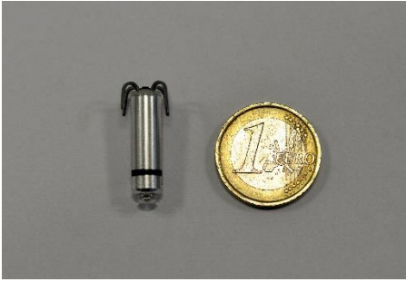
Kaum größer als eine 1-Euro-Münze: Der kabellose Mini-Schrittmacher
